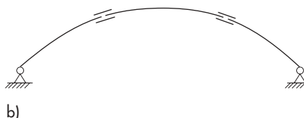
Figur 10.3 Lämplig placering av skarvar i bågkonstruktioner.
