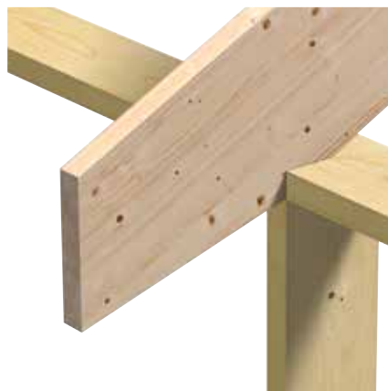
Endeopplegg med garp.
