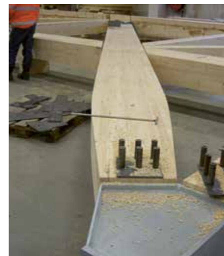
Produksjon av bærebjelker til Gardermoen flyplass.
