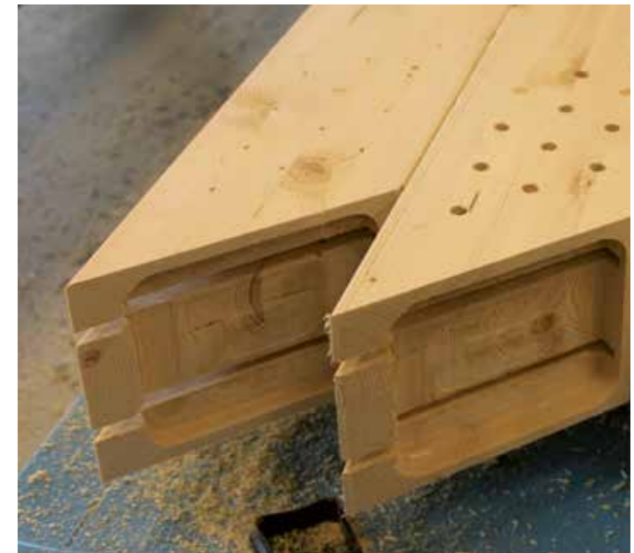
Fresing av bjelker til Gardermoen flyplass.
