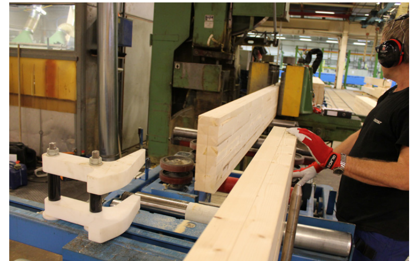
Nøyaktig splitting av S-bjelken
