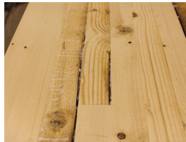
Bjelken kan ha uhøvlet og ujevn overflate, og egner seg best til skjulte konstruksjoner.
