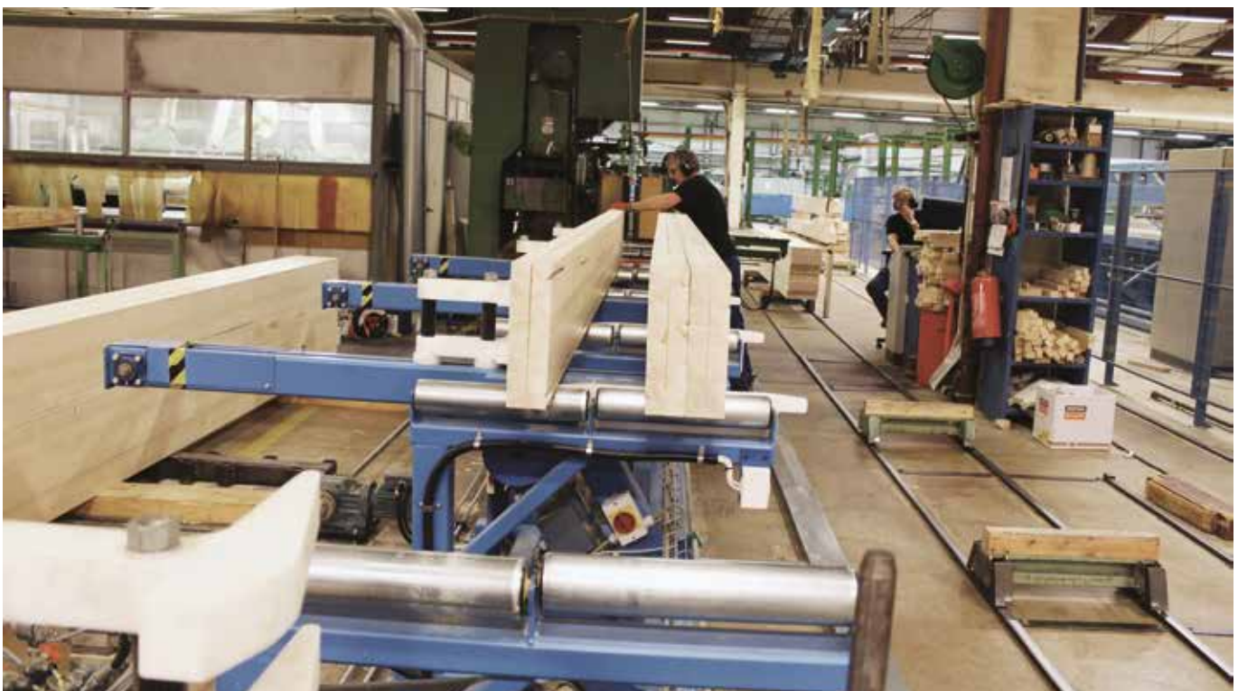
Splitting av bjelkene foregår på en effektiv måte i fabrikk.
