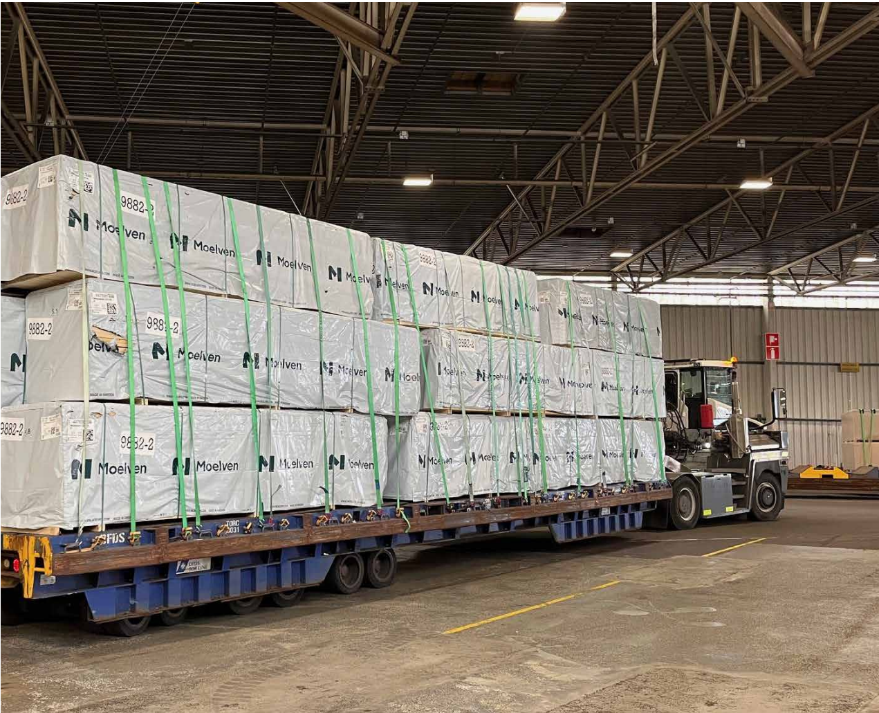
Gods på båt og bane: Klimaavtrykket fra transport reduseres ved å utnytte jernbane- og båttransporter i størst mulig grad. En ferdig lastet «flatbed», eller lastbærer, for transport av trelast på båt fra Göteborg til Storbritannia. Et slik flak laster gods tilsvarende 2-3 vogntog. Det er også mulig å sette sammen lass i samarbeid med andre aktører. Trelasten tar dermed «kollektivtransport» til havn i Storbritannia, før den blir lastet om for «last mile» distribusjon til sluttkunde.
