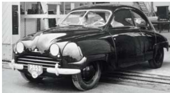
Den aller første Saab-bilen, "Ur-Saab" (bildet til høyre), ble utviklet i 1946 av flyprodusenten Svenska Aeroplan Aktiebolaget. "Ur-Saab" var en prototyp på Saabs første personbil Saab 92 (bildet til venstre) som man startet å serieprodusere i 1949. Saab 92 hadde forhjulsdriфт, torsjonsfjæring, tannstagsstyring og selvbærende karosseri med meget gode aerodynamiske egenskaper allerede for seks tiår siden. Avansert skandinavisk teknikk og design med høy kvalitet har et marked over hele verden.
