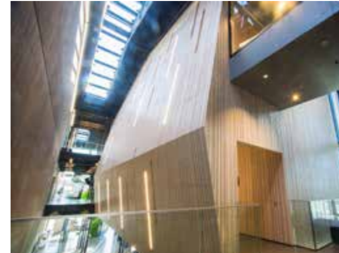
Eco Panel til vegg og himling Kan leveres i eik, ask og furu Innfarget og/eller med brannlakk i B-s1,d0. Standard elementer er 60x240 cm, andre dimensjoner på forespørsel
