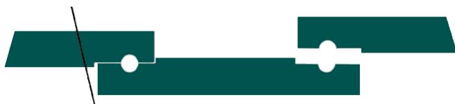
Figur 1: Festes kun i overliggeren, med 75 mm rustfrie A2 eller A4 skruer
